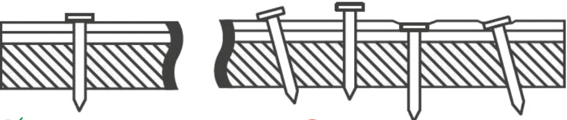
Рис. 3. Пример правильной забивки гвоздей при монтаже продукции.
