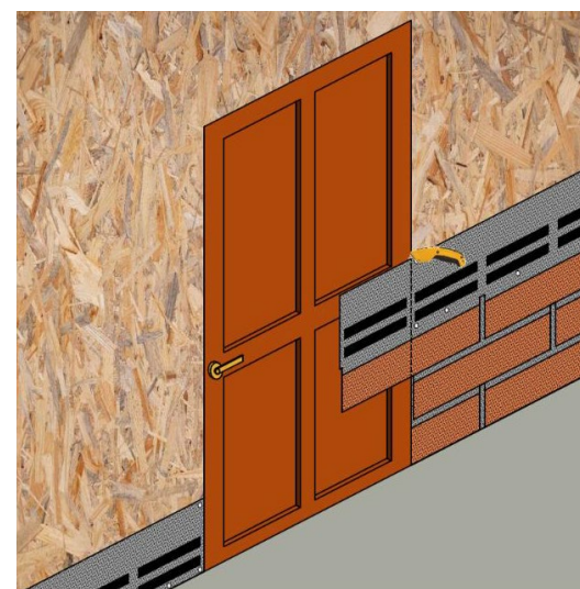
Рис. 31. Монтаж фасадной плитки вокруг дверного проёма.
