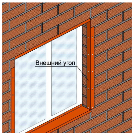
Рис. 30. Обрамление оконного проёма при помощи внешнего угла (тип 2, таблица №2).
