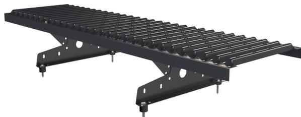
В случае необходимости платформа переходного мостика обрезается с помощью электролобзика или ножовки по металлу до необходимой длины. Запрещено использование абразивного режущего инструмента (болгарка).
